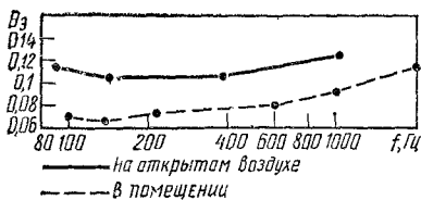
Рис. 4.3. Зависимость декремента затухания деки от частоты
