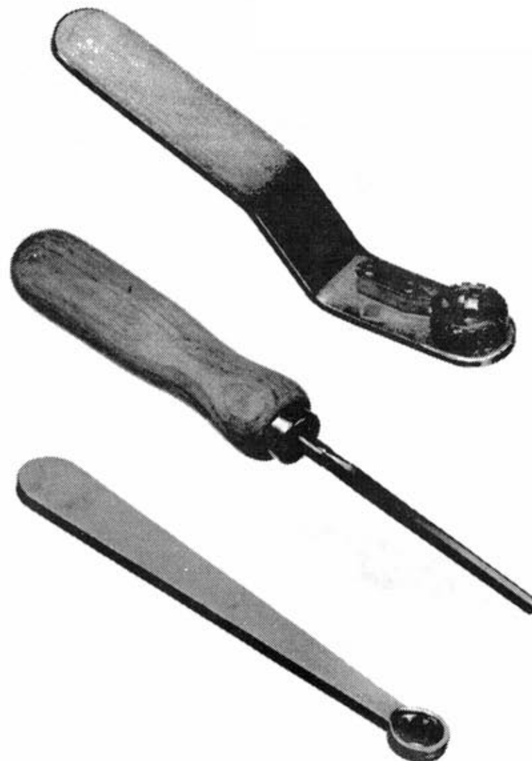
Ключ для регулировки храпового механизма Развертка Ключ для регулировки установочных винтов
