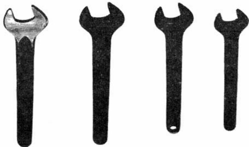
Колотушка для обстукивания клавиатурной рамы Гаечный ключ 10 мм для регулировки сдвига клавиатуры Гаечные ключи 11 и 12 мм для штанги лиры Гаечный ключ 13 мм для педали sostenuto
