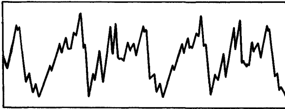
Схема 8. Форма колебаний скрипичной струны
