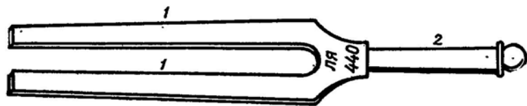
Рис. 25. Камертон: 1 — ветви; 2 — ручка.
